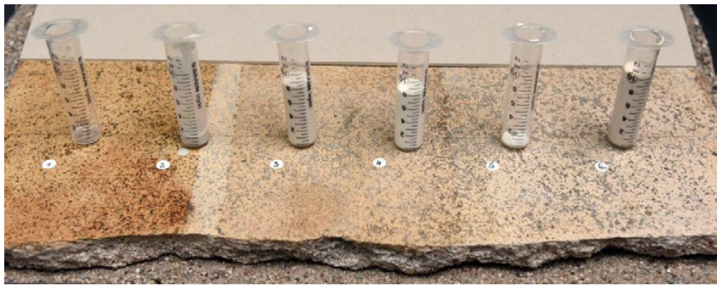
Abb. 14: Packer mit Materialproben zur Beprobung der Fließfähigkeit
