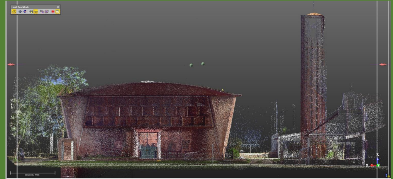
Levantamiento tridimensional: fachada norte. Imagen ITGA S.R.L.
