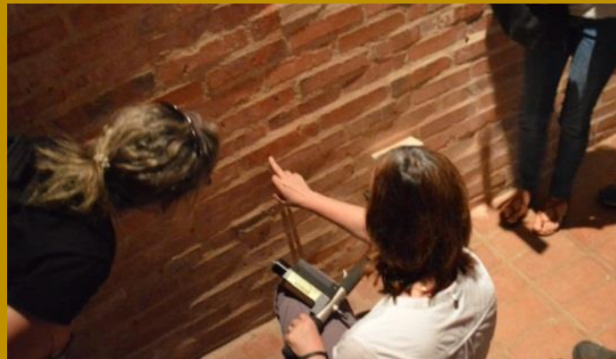
Ground Penetrating Radar (GPR) en el muro Este del templo y gráfica donde se aprecian las hipérbolas características de reflectores puntuales por presencia de los refuerzos metálicos
