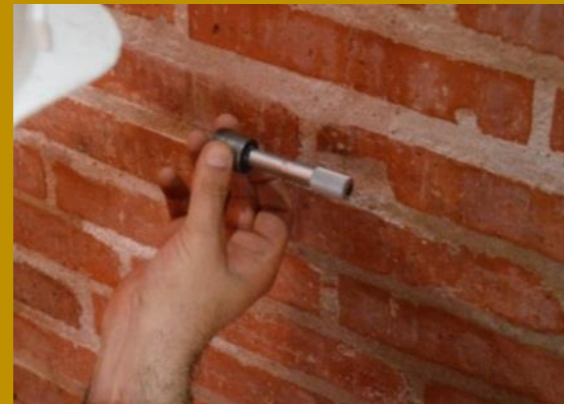
Técnicas de esclerometría y ensayos de penetración.
