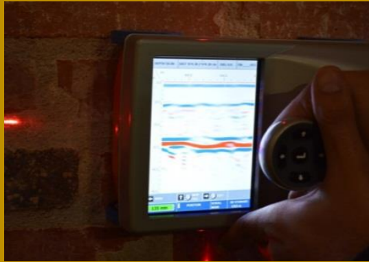
Ground Penetrating Radar (GPR) en el muro Este del templo y gráfica donde se aprecian las hipérbolas características de reflectores puntuales por presencia de los refuerzos metálicos
