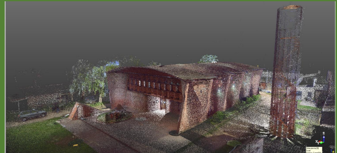
Levantamiento tridimensional: vista exterior desde el noroeste. Imagen ITGA S.R.L.
