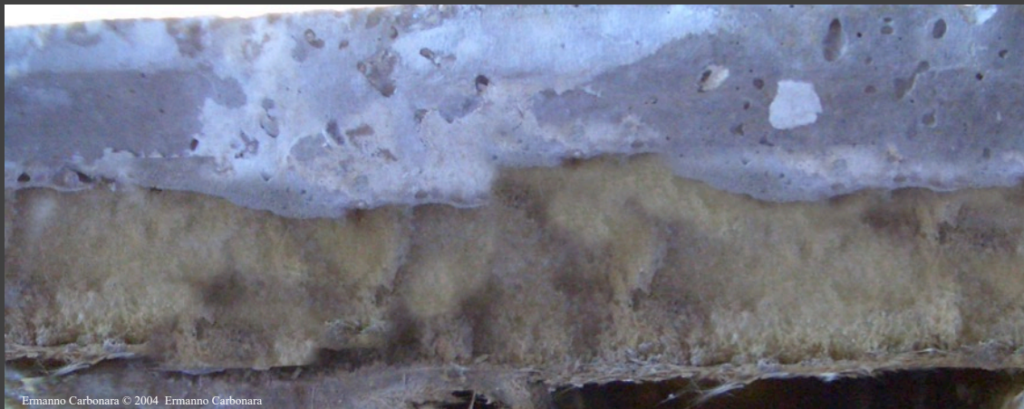
Panneau composé d'une mousse de polyuréthane entre deux couches de résine armée de fibres de verre
