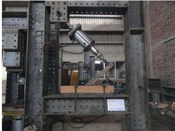
FIGURA 5.5. Configuración del ensayo para la unión clavada entre el poste y la riostra diagonal.
