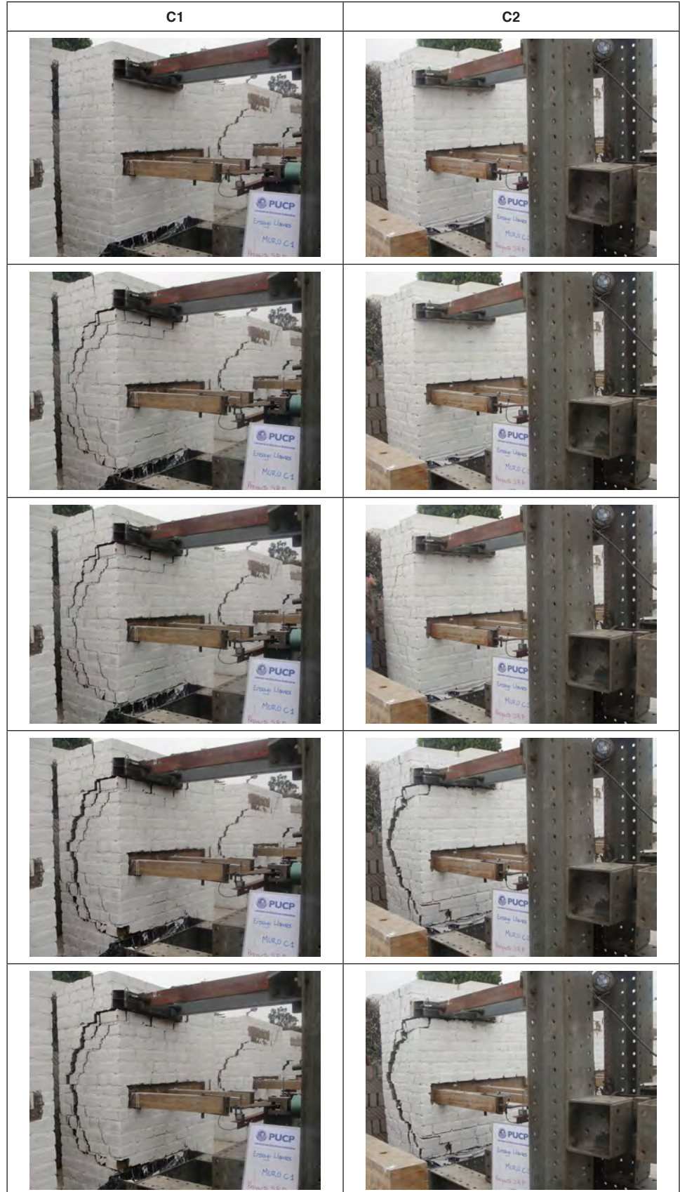
FIGURA 6.20. Propagación de grietas durante los ensayos de los especímenes tipo C.
