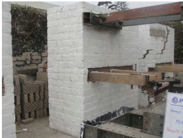
FIGURA 6.12. Configuración completa del ensayo del esquinero.
