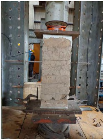
FIGURA 2.8. Ensayo de compresión en la pila de adobe. Se observan grietas verticales en las unidades y en el mortero.
