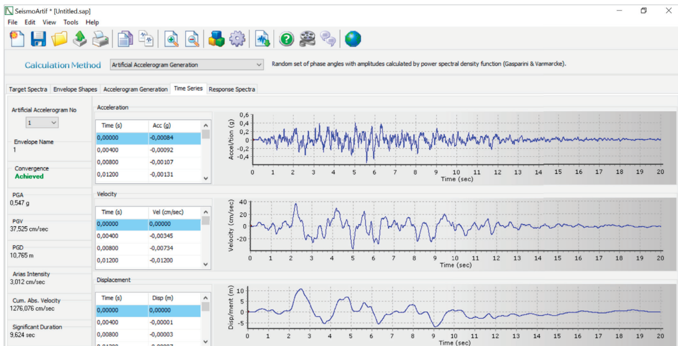
FIGURA 2.12. Ejemplo de una generación de acelerogramas artificiales espectro-compatibles (software SeismoArtif 2016 de SeismoSoft).
