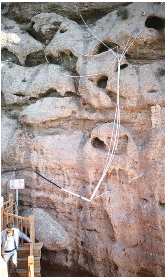
应尽量减少监测设备的接线或将它们隐藏起来，不宜暴露在外。
