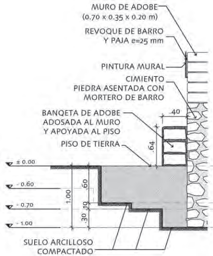
FIGURA 5.15 Cala IS-3, sección del sobrecimiento en la esquina suroeste de la iglesia principal. Dibujo: Mirna Soto, para el GCI.
