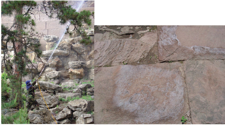
1、2. 殊像寺，主要假山的前面 没有管制地喷洒杀虫剂导致盐（左）、霜出现在埧地砖上（右）。 Shuxiang Temple, in front of main rockery Uncontrolled pesticide spraying (left) and resulting salts in paving stones (right)
